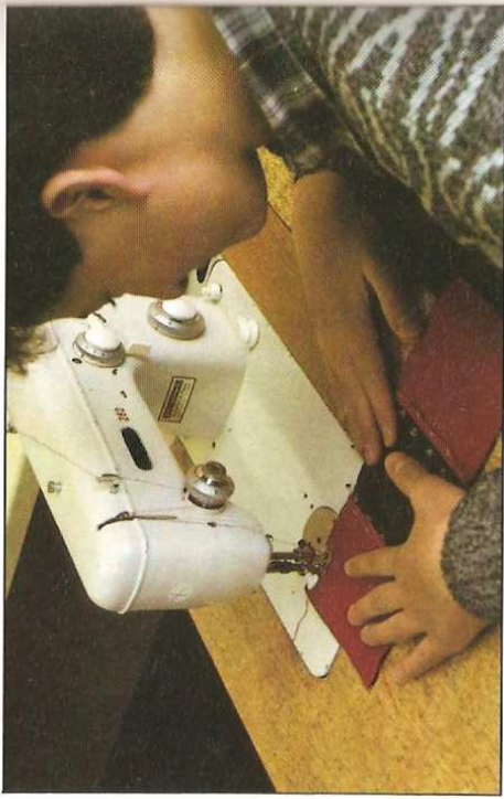
Zwei Teile werden mit der Maschine zusammengesteppt.
